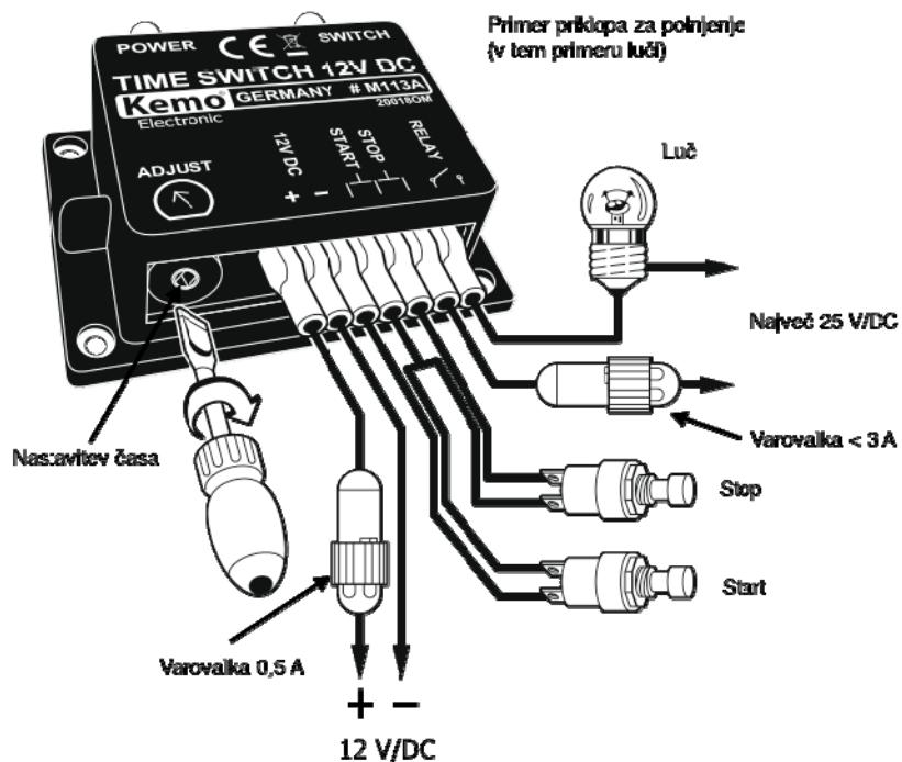
Kable modula speljite kot prikazuje načrt vezave. Časovno obdobje med 2 sekundama in 23 minutami ( $\pm 30\%$ ) lahko nastavite z vgrajenim kontrolerjem (preizkusite).
