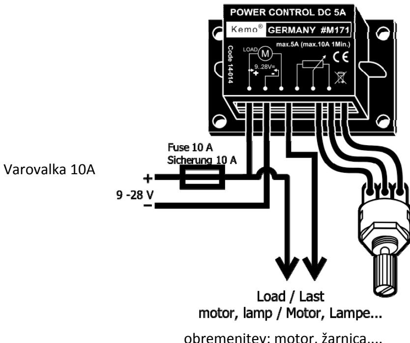
Obratovalna napetost (na primer z akumulatorja) in obremenitev (na primer motor enosmernega toka) morata biti priklopljena tako, kot je prikazano na sliki. Kabli morajo biti čimkrajši in s primernim prezom (1.5 do 2.5 mm<sup>2</sup>). Pri pretankih in predolgih kablih pride do izgube moči v kablu in motor deluje počasneje. Dodatno pa pri pretankih kablih obstaja nevarnost, da se zelo segrejejo zaradi visokih tokov ki tečejo skozi njih.
