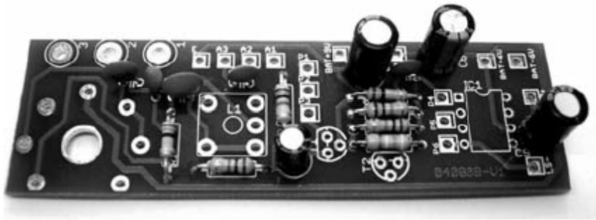
Vstavljanje elektrolitskih kondenzatorjev
