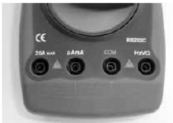
Slika 17: Večina multimetrov je opremljenih z 3-4 priključki, na katere priključite merilne kable, glede na meritve.
