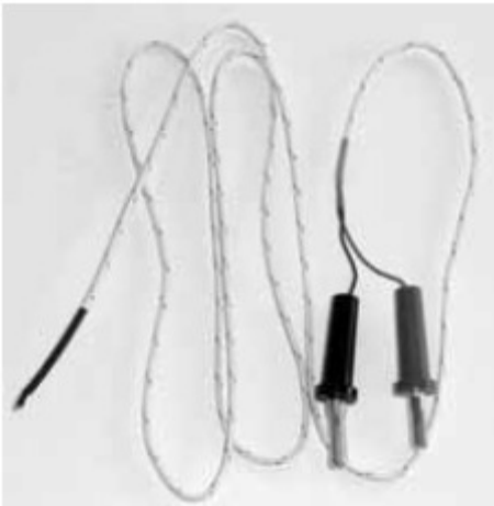
Slika 78: Za merjenje uporabite tako imenovan NiCrNi (nikelj-krom-nikelj tip K) senzor. Narejen je za temperature do +400^{\circ}\text{C} .
