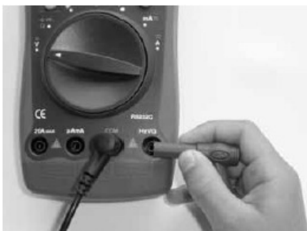
Slika 19: Če naj bodo izvedene meritve napetosti in upornosti, je potrebno pri tem modulu rdeč merilni kabel priključiti na desni priključek »HzVΩ«. Za merjenje manjših tokov je potrebno kabel priključiti na priključek »μAmA«.
