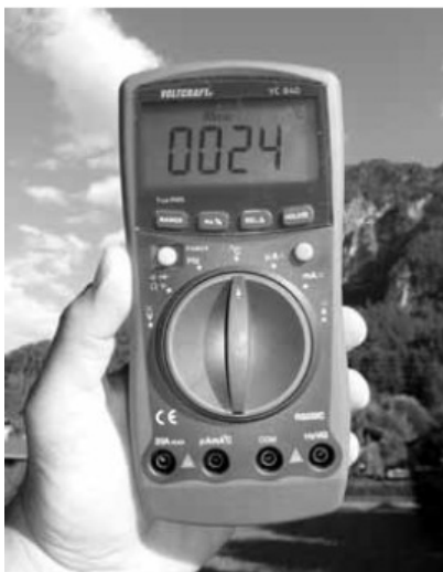
Slika 77: Takoj, ko ste na multimetru nastavili merilno območje temperature, lahko merite temperaturo okolja.
