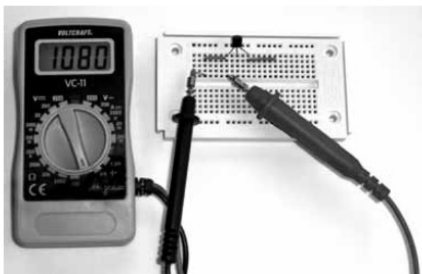
Slika 73: S preprostimi multimetri je lahko izvedena preveritev, če je tranzistor v redu. Za testiranje NPN tranzistorja morate rdeč merilni kabel priključiti na bazni priključek, črnega izmenično na zbiralnik in sevalnik.
