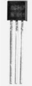
Slika 12: Tranzistor s pogledom na sploščeno stran. Priključki z leve proti desni: zbiralnik (C), baza (B) in sevalnik (E).
