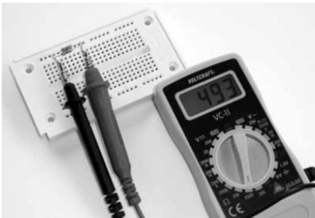
Slika 33: Dva vzporedno vezava 1k\Omega upora podata skupno upornost 493\Omega . Ker to še ni točno 500, je zaradi toleranc pri izdelavi uporov.
