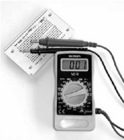
Slika 25: V največjem nastavljenem merilnem območju, rezultati merjenja še niso popolnoma točni.
