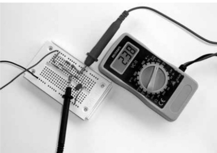
Slika 65: Skozi oba 330\Omega upora teče okoli 2,4mA.
