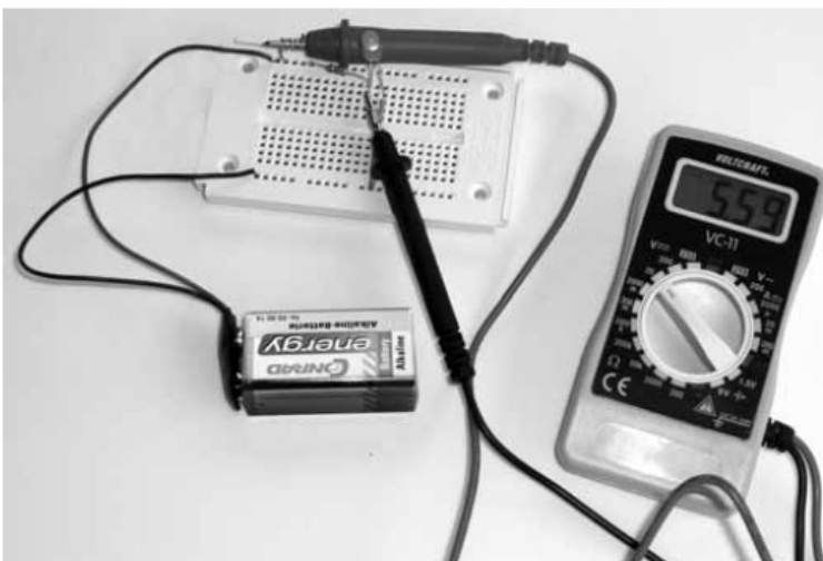
Slika 45: Na 1k\Omega uporu pade napetost 5,59V. Za natančno merjenje napetosti je vedno postaviti optimalno merilno območje.
