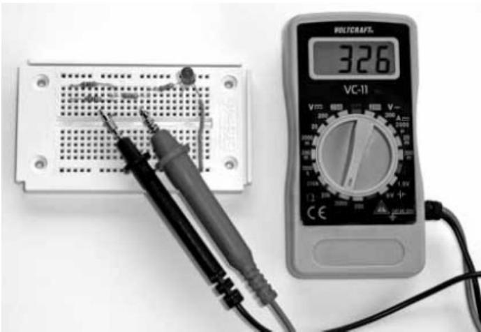
Slika 59: Merjenje posameznih upornosti v vezju deluje samo, če k njim niso vzporedno vezani drugi gradbeni deli.
