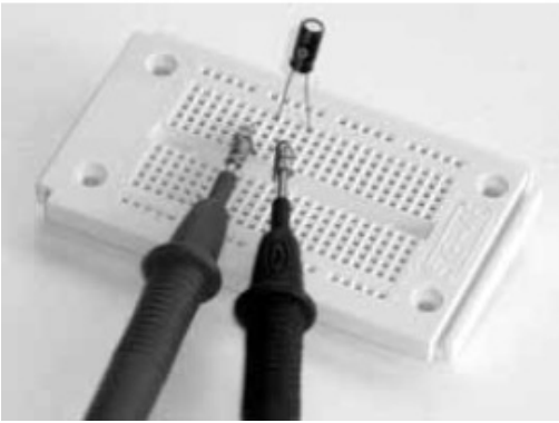
Slika 34: Kondenzatorje lahko merite samo izven vezij ali delov vezij. Kondenzator za merjenje nataknete na preizkusno ploščo. Oba merilna kabla je potrebno na kondenzator priključiti glede na pravilno polarnost.
