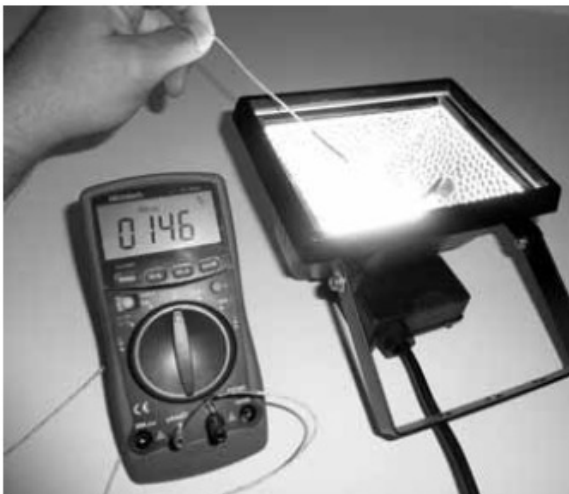
Slika 80: Tukaj bo izmerjena temperatura zraka v bližini halogenskega reflektorja. Visokim temperaturam je lahko izpostavljena samo merilna konica žičnega temperaturnega tipala.
