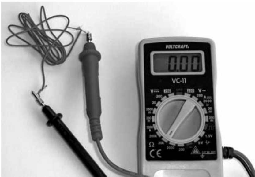
Slika 52: Merjenje prevodnosti na kablu.
