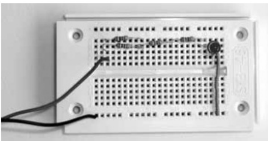
Slika 54: Izgradnja mešanega vezja z zaporedno in vzporedno vezavo, ki upravlja LED.
