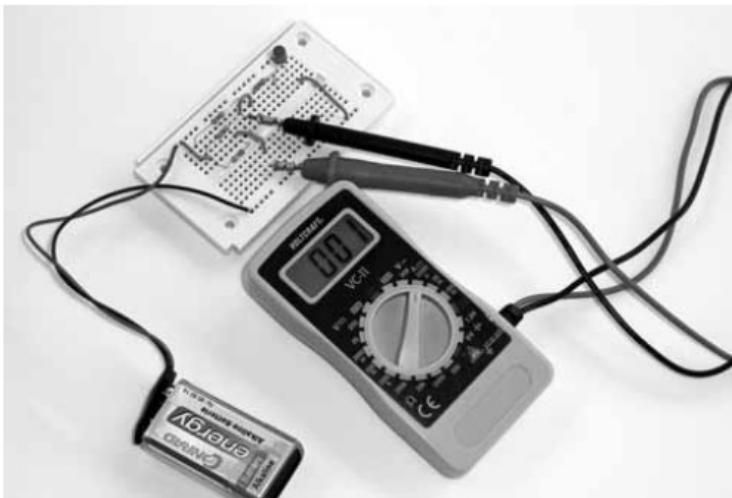
Slika 64: Skozi zelo visok 2,2\text{M}\Omega tok skoraj ne teče. Izmerjena vrednost 1mA je razložena samo z visoko napako meritve. Dejansko je bistveno manjša.
