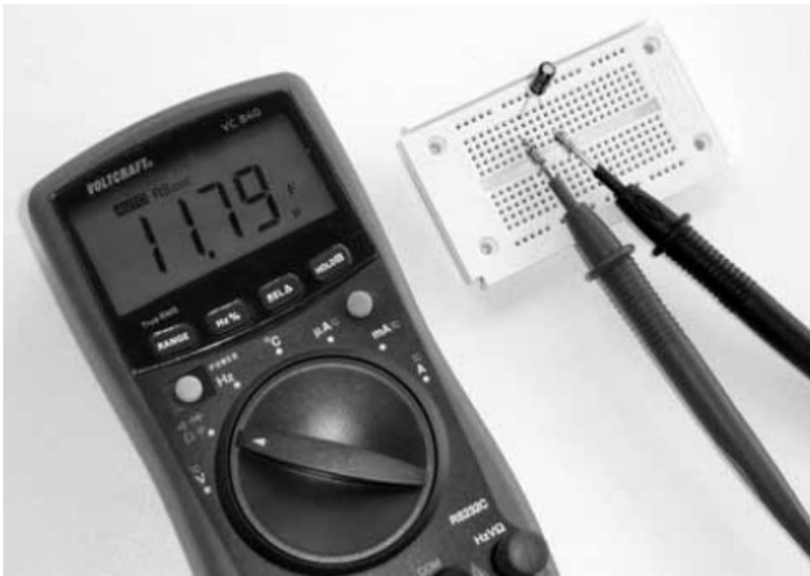
Slika 35: Na multimetru je potrebno nastaviti merilno območje kapacitete. Traja nekaj sekund, da lahko odčitate izmerjeno vrednost.
