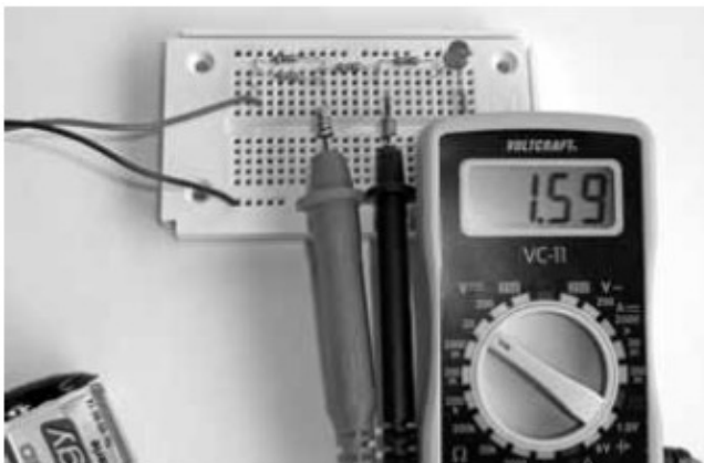
Slika 56: Na dveh eno velikih zaporedno vezanih uporih vedno vsakokrat pade ista napetost.
