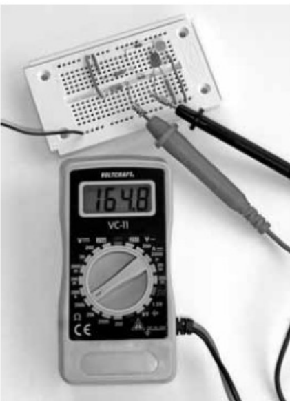
Slika 71: Če boste rdeč merilni kabel držali na z obročem označeni strani diodi, bo merjenja prevodna smer.
