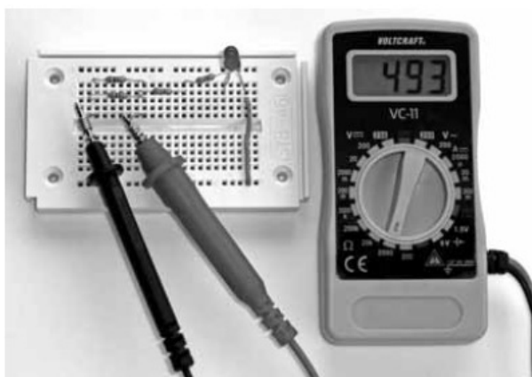
Slika 57: Na obeh v vezju vzporedno medsebojno vgrajenih 1k\Omega uporih, je lahko izmerjena samo skupna upornost 493\Omega .
