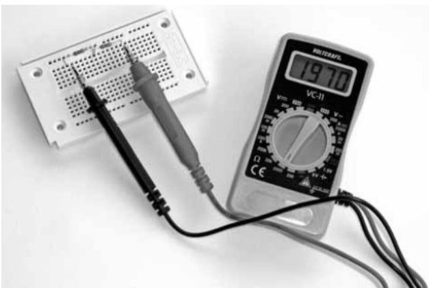
Slika 30: Skupna upornosti pri zaporedni vezavi vedno ustreza vsoti vrednosti posameznih uporov.
