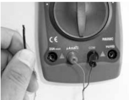
Slika 79: Črn merilni kabel morate povezati s priključkom COM instrumenta. Rdeč merilni kabel priključite na priključek » \Omega\text{mA}^{\circ}\text{C} «.
