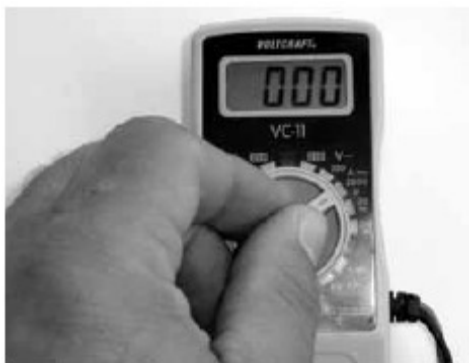
Slika 20: Paziti je potrebno na izbiro pravilne merilne veličine (npr. »enosmerni tok«, ko naj bodo merjeni enosmerni toki)
