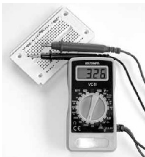
Slika 27: Pri pravilni nastavitvi izmerjene vrednosti se drug izkaže kot 330\Omega upor.
