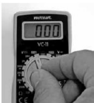
Slika 21: Pred vsako meritvijo je potrebno merilni instrument najprej preklopiti na maksimalno merilno območje. Pri tej napravi znaša v območju enosmerne napetosti 250V.
