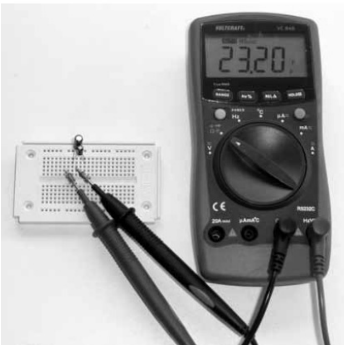
Slika 41: Pri dveh vzporedno vezanih 10\mu\text{F} kondenzatorji merite vsoto posameznih kapacitet obeh kondenzatorjev.
