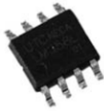
Slika 16: Pri SMD integriranem vezju je PIN 1 označen s piko na zgornji strani ohišja.
