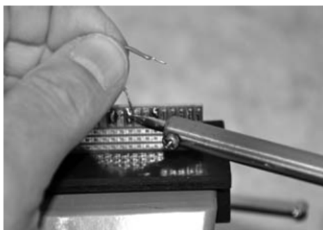
Slika 35: Medtem ko segrevate spajkano površino, s prsti rahlo vlecite za žico, dokler se ne loči od površine.
