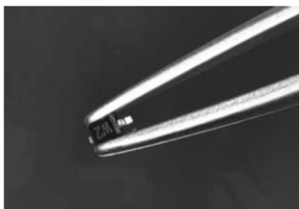
Slika 14: SMD-diode so izjemno majhne.
