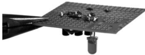
Slika 63: Priključne žice je treba odščipniti tik nad spajkanimi stožci.
