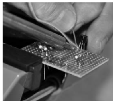
Slika 55: Spajkanje priključka tranzistorja mora biti zaključeno v nekaj sekundah.
