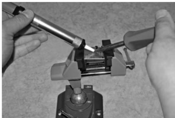
Slika 65: Odspajkanje deluje samo s pomočjo odspajkalne črpalke.
