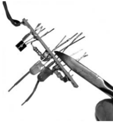
Slika 61: Potem ko dokončate in pregledate vezje, je treba prekomerne dolžine priključnih žic odščipniti s ploščatimi kleščami za elektronike.
