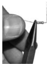
Slika 29: Pri električnih komponentah žic ne smete upogibati neposredno na koncu ohišja.
