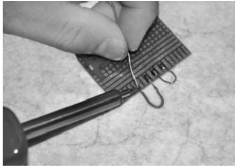
Slika 30: Prispajkanje žičnih mostičkov na stranski črtni raster
