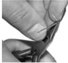
Slika 28: Žico pravilno upognete z okroglimi kleščami za elektronike.
