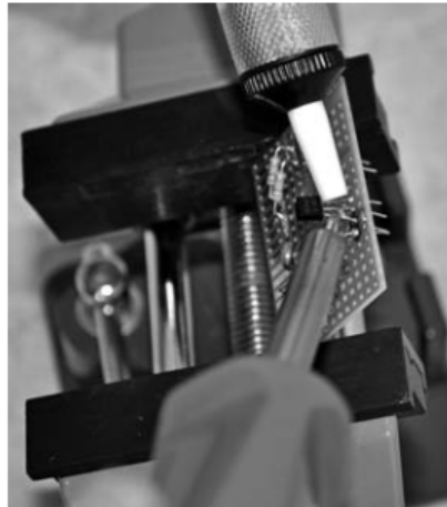
Slika 57: Grude spajke lahko odstranite s segrevanjem in sesanjem z odspajkalno črpalko.
