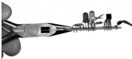
Slika 62: Odščipnjeni priključki morajo za 0,5-1 mm štrleti nad vezjem.
