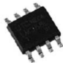
Slika 16: pri SMD IC je PIN 1 označen s piko na zgornji strani ohišja.
