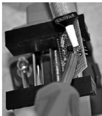
Slika 57: grude spajke lahko odstranite s segretjem in odsesvanjem z odspajkalno črpalko.
