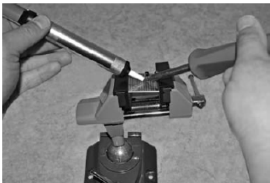
Slika 65: odspajkanje deluje samo s pomočjo odspajkalne črpalke.
