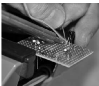
Slika 55: spajkanje priključka tranzistorja naj bo zaključeno v roku nekaj sekund.
