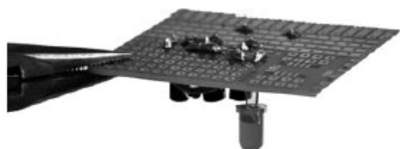
Slika 63: priključne žice so odrezane tesno nad stožci spajke.
