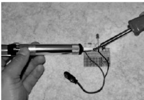
Slika 42: velike količine spajke, kot tukaj spajkalni mostiček med uporom in LED, lahko odstranite samo z odspajkalno črpalko.
