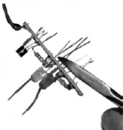
Slika 61: odvečne dolžine priključnih žic morate po izdelanem vezju in preveritvi vezja odrezati z kleščami.
