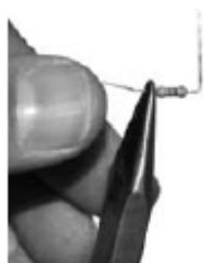
Slika 30: pri električnih komponentah naj žice ne bodo upognjene direktno na koncu ohišja.
