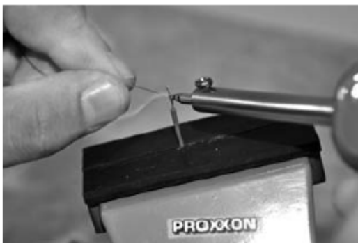
Slika 27: zvito žico je potrebno segreti in dodati nekaj kositrove spajke, ki se takoj stali.
