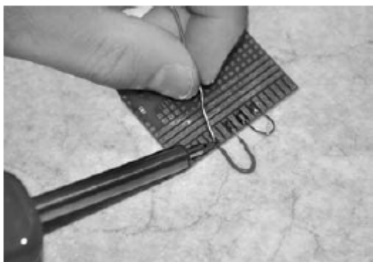
Slika 31: spajkanje žičnih mostičkov na stranskem črtastem rasterju
