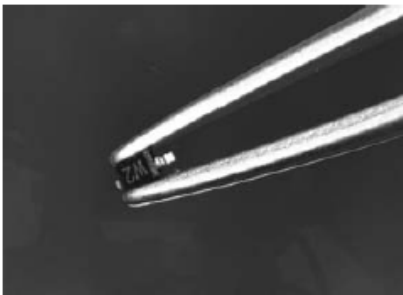
Slika 14: SMD diode so zelo majhne.
