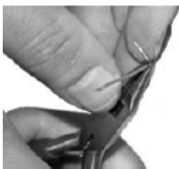
Slika 29: žica bo upognjena z kleščami za elektroniko.
