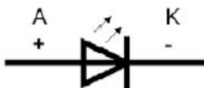
Slika 10: znak LED na vezalnem načrtu (vezju)
