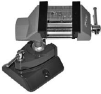
Slika 19: v fino mehanski primež lahko plošče dobro vpnete in jih udobno spajkate.
