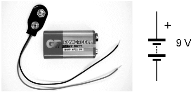
Skica 3: Baterija – realni in shematski simbol
