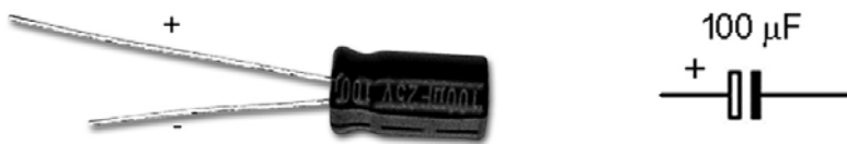
Skica 11: Elektrolitski kondenzator
