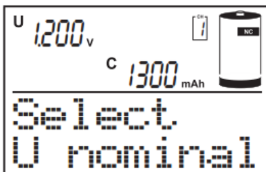
Slika 22: izbira nazivne napetosti akumulatorja
