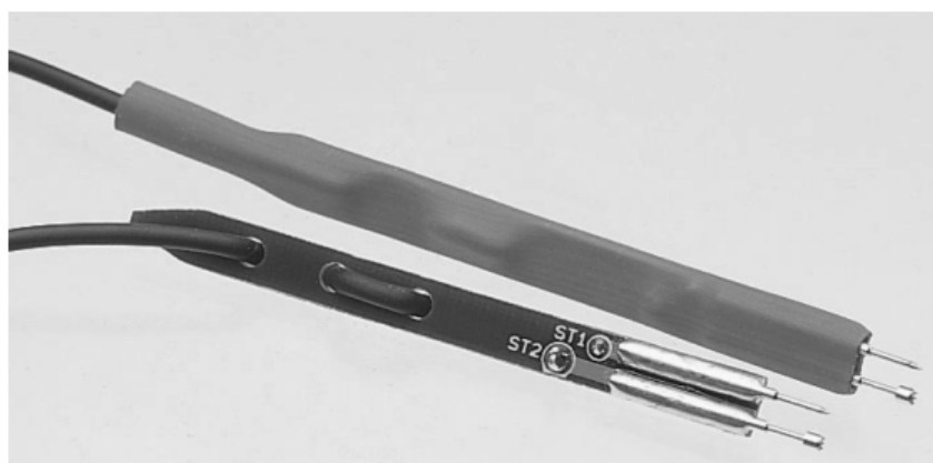
Slika 38: posebne merilne konice za merjenje notranje upornosti akumulatorja
