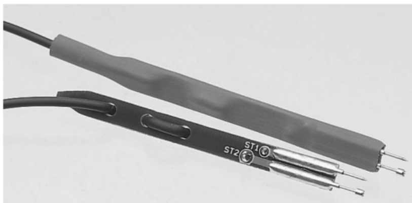
Slika 7: posebne merilne konice za merjenje notranje upornosti akumulatorja
