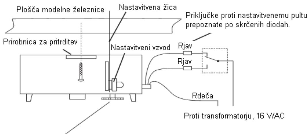
Potem ko odstranite nastavitvene žice, lahko s to tipko fiksirate pomikalnik v sredinskem položaju, kar omogoča natančno montažo.
