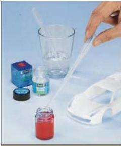
5. Vedno prišite enakomerno: najprej nanesite tanko plast barve na vse robove. Nato je pomembno, da na ostale površine razpršite tanko plast barve: ne preveč na debelo, ker se sicer barva pocedi – in ne preveč na tanko, da ne boste dobili učinka pomarančnega olupka. Če želite (kot v tem primeru), lahko pred barvanjem na površine nanesete "Aqua Color Basic" (temeljno barvo).
