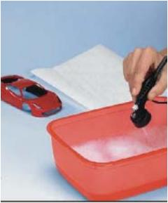
7. Čiščenje barv na vodni osnovi ("Aqua Color"): osušene ostanke barve očistite s čistilom "Aqua Color Clean". Pri čiščenju sta uporabna pripomočka vatirane palčke in vpojne kuhinjske brisačke.
