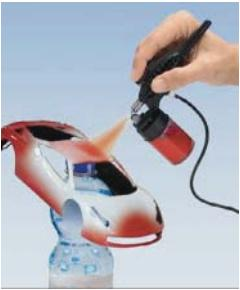
6. Čiščenje pršilne pištole: nič ni bolj pomembno od pravilnega čiščenja pršilne pištole: odvijte posodo z barvo. Na vpojno kuhinjsko brisačko razpršite morebitne ostanke barve. Pršilno pištolo držite v posodi z vodo tako, da je sesalna cev potopljena. Mešanico barve in vode razpršite direktno v posodo.
