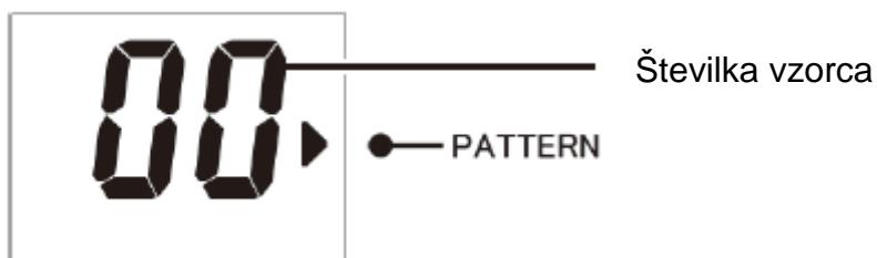
2. Iz seznama vzorcev na konzoli ⑥ ali v teh navodilih za uporabo izberite želeni vzorec in si zabeležite njegovo številko. Vnesite številko vzorca s tipkami ⑯ (številske tipke, +, -).
