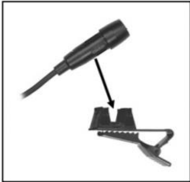
Slika 2: Pritrditev mikrofona na sponko za pritrditev
