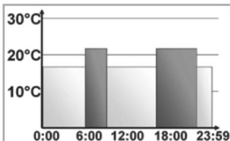
Stolci za čase ogrevanja so na prikazovalniku vedno prikazani takrat, ko je nastavljena temperatura za časovni interval višja od nastavljene temperature varčevanja. V tem primeru na prikazovalniku ni stolpcv za časovni interval od 0:00 do 6:00. Na prikazovalniku se pojavijo samo stolci za intervale od 6:00 do 9:00 in od 17:00 do 23:00.
