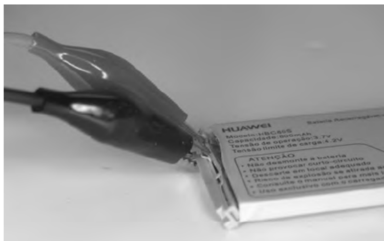
Slika 039: Povezava sponk s kontakti akumulatorske baterije
