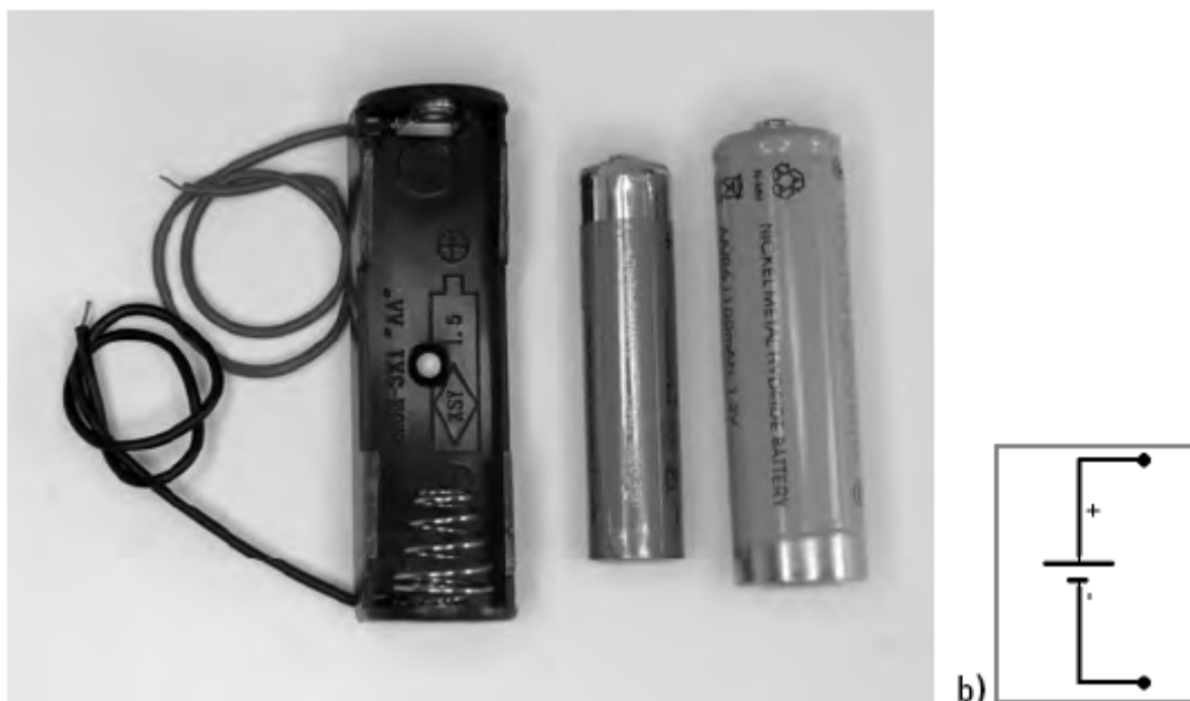
Slika 011: a) Držalo za akumulatorsko baterijo, b) Stikalni simbol za akumulatorsko baterijo
