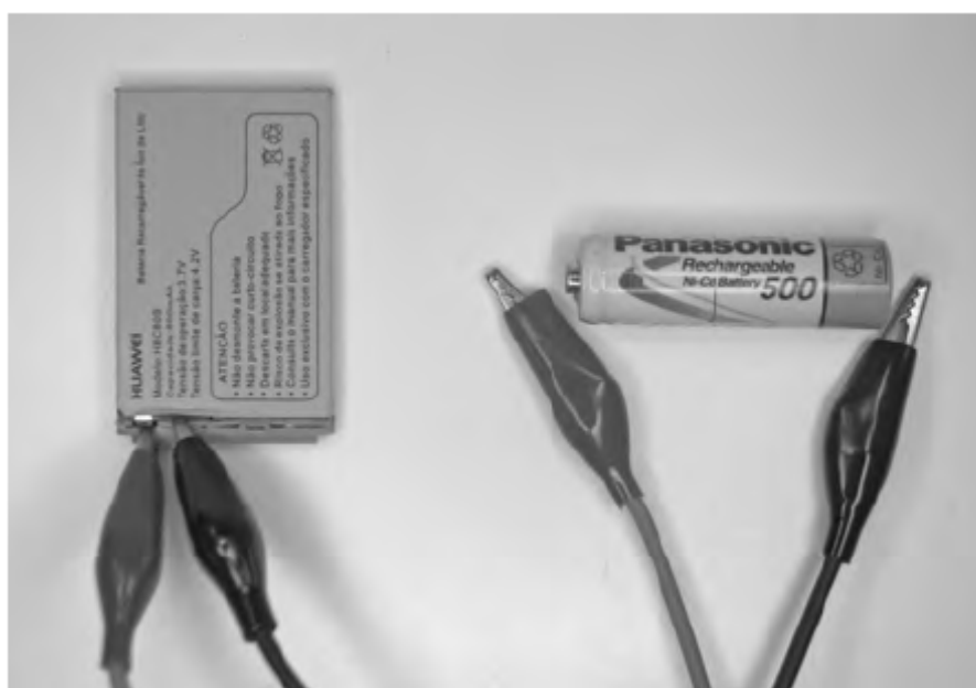
Slika 070: Uporaba z litijevo akumulatorsko baterijo in kabloma s krokodil sponkami
