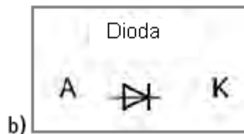
Slika 004: a) Silicijeva dioda tipa 1N 4001; Katodo diode prepoznate po natisnjeni črtici, druga priključna žica pa je anoda. Tehnična smer toka poteka od anode proti katodi. b) Stikalni simbol diode
