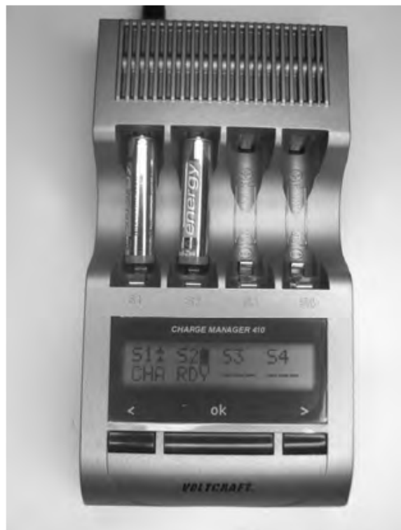
Slika 035: Profesionalni polnilnik za nikelj-cinkove akumulatorske baterije velikosti AA in AAA
