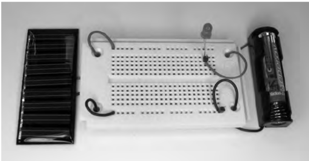
Slika 053: Sestava preizkusne ploščice: enostaven solarni polnilnik z LED kot prikazom napoljenosti
