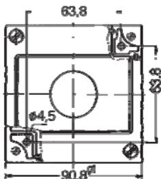
Stikalo za mrak namestite le na gladko, vertikalno steno, ki je obrnjena proti severu in ni izpostavljena direktnemu soncu.
