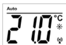
Če radiatorski termostat MAX! uporabljate v kombinaciji s sobnim termostatom MAX!, potem se sobna temperatura meri na sobnem termostatu MAX!. Zato se lahko zgodi, da je nekje drugje v prostoru hladnejše ali toplejše. Če želite temperaturo izenačiti, lahko na sobnem termostatu MAX! ali v programski opremi nastavite offset temperaturo ±3,5 °C. Če termostat izmeri npr. 18 °C namesto nastavljenih 20 °C, je treba nastaviti offset -2,0 °C.
