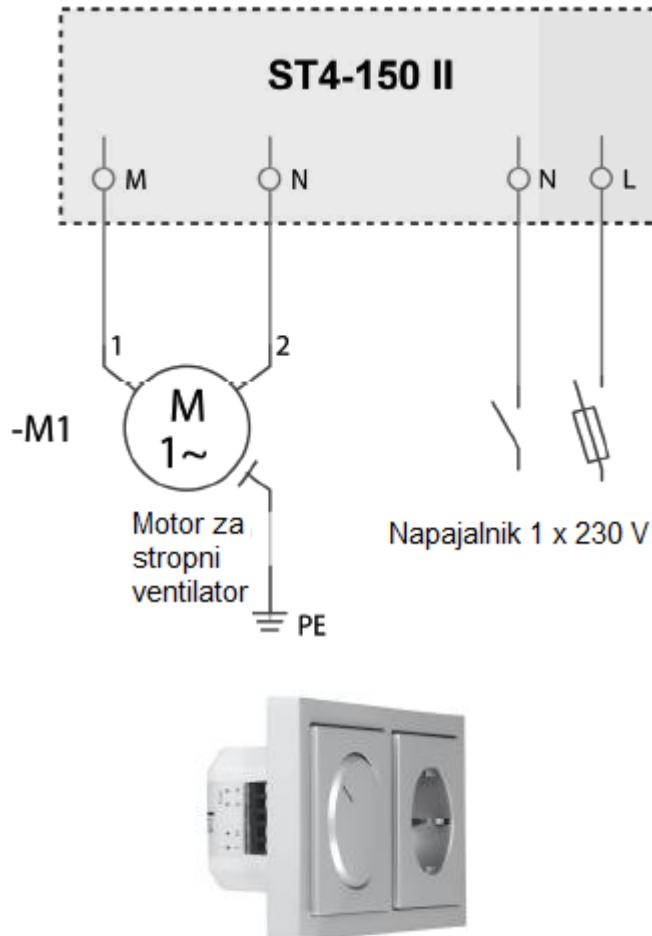
**ST4-150 II, #85215** – vgradnja v okvir drugega proizvajalca z vrtljivim gumbom, okvir in krovna plošča sistemov drugih proizvajalcev s 6 mm osjo.
