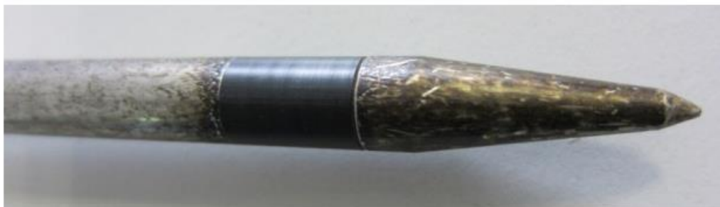
Umazana sonda -> napačna meritev!
