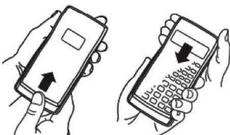
Pred uporabo kalkulatorja trd pokrov ohišja kalkulatorja potisnite navzdol in ga odstranite, nato pa ga namestite na zadnjo stran kalkulatorja, kot je prikazano na zgornji sliki.
