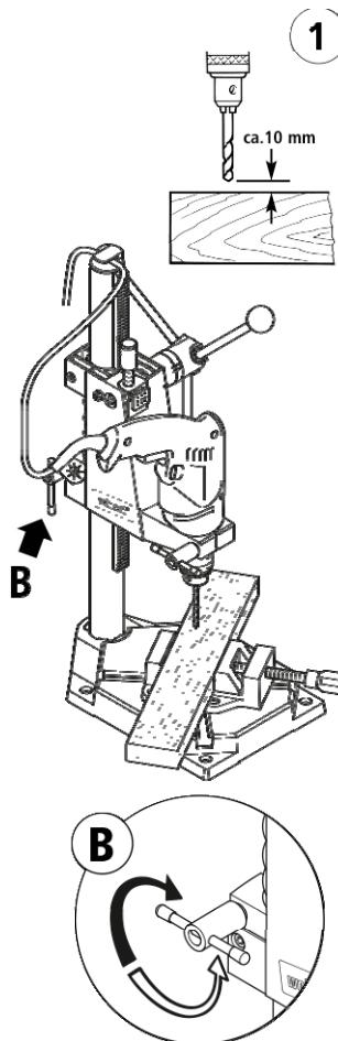
2. Vrtalno konico s predmetom obdelave premaknite z upravljanjem ročaja oprijema. Lestvico nastavite na 0.
