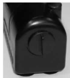
Pri vrtenju ne uporabljajte sile, saj ima vrtljivi gumb mehanske omejitve v posameznih skrajnih legah.
