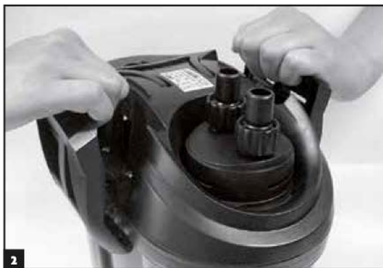
Slika 2 – Glavo filtra odprite tako, da od zgoraj sprostite sponke in jih povlečete navzven. Glava filtra se sprostí iz svojega položaja.
