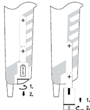
Baterije je treba zamenjati, ko stopenjski prikaz (8) pri testiranju delovanja več ne sveti, ko se na LCD-prikazovalniku pojavi simbol za menjavo baterij ali ko pa pri medsebojnem stikaju testnih konic (4 in 6) več ne slišite zvočnega signala.
