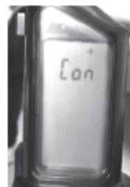
Merilni konici povežite s predmetom merjenja. Pri prevodnosti do maks. 400 kΩ +50 % zaslišite zvočni signal, na LCD-prikazovalniku pa se pojavit simbol za prevodnost (7) in napis Con.
