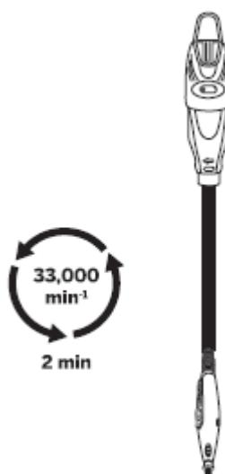
Za optimalni učinek pred začetkom uporabe pustite, da se vaš novi Flexshaft z visoko hitrostjo vrti na vašem rotacijskem orodju v navpičnem položaju približno 2 minuti.
