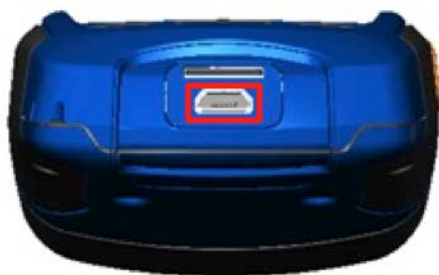
Slika 5: prikaz odprtega pokrova naprave in označen USB vhod
