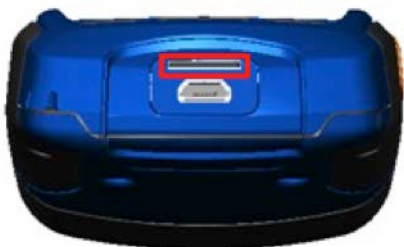
Slika 41: prikaz odprtega pokrova naprave in označena reža za microSD kartico
