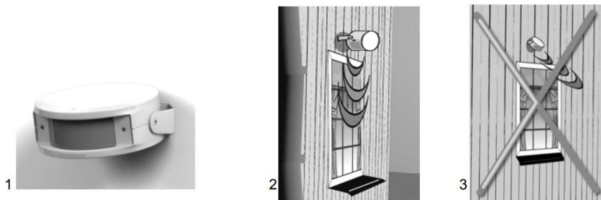
Senzor (1) namestite na mesto, kjer mačka/pes običajno čaka na vstop. Pri tem uporabite ustrezne vijke. Poiščite ustrezen kot in položaj, označite luknje za pritrditev in nato odstranite pritrdilno zanko pred pritrditvijo z vijaki. Senzor namestite v pritrdilno zanko.
