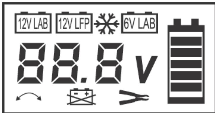
Načini polnjenja so 12V LAB za 12 V svinčeve akumulatorje v izvedbi s kislino in gelom ter AGM-akumulatorje, 12V LFP za 12 V akumulatorje LifePo4 in 6V LAB za 6 V svinčeve akumulatorje v izvedbi s kislino in gelom. V vseh načinu, razen pri 12V LFP, lahko s ponovnim pritiskom tipke MODE aktivirate zimski način, ki ga prepoznate po snežinki, tako da lahko akumulatorje polnite tudi pri nizkih temperaturah.
