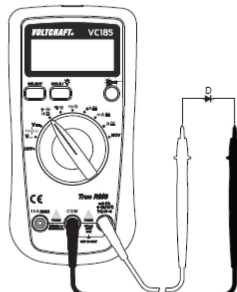
merilna konica pa minus polu. Prikaže se merilni rezultat. Zamenjajte testna kabla, da preverite prevodnost v drugi smeri.
