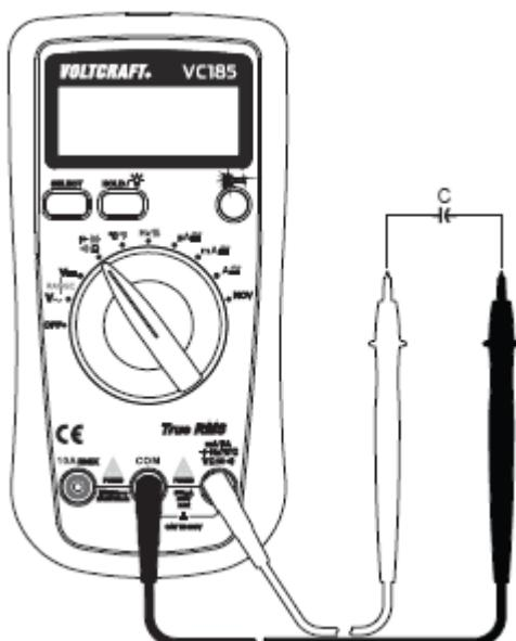
→ Preden se lotite merjenja se prepričajte, da ste ločili vse vire napajanja, razelektrili vse kondenzatorje in da ste komponento, ki jo želite izmeriti, ločili od ostalih komponent v električnem krogu.
