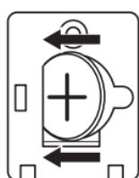
Obrišite površino nove baterije s suho, čisto krpo. Vstavite jo v kalkulator tako, da je pozitiven pol (+) obrnjen navzgor.
