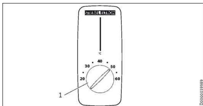
1 Nastavitiveni gumb za temperaturo, nastavitev temperature: 20 °C - 60 °C
