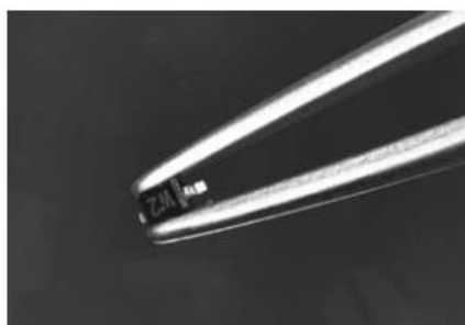
Slika 14: SMD-diode so izjemno majhne.
