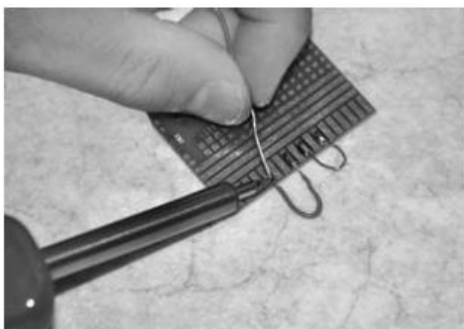
Slika 30: Prispajkanje žičnih mostičkov na stranski črtni raster
