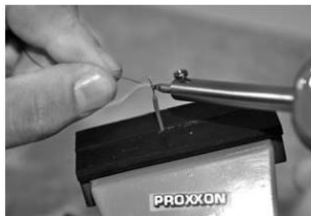
Slika 26: Prepleteno žico segrejte in dodajte malce spajke, ki se takoj stali.
