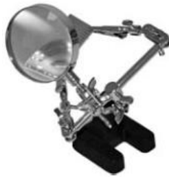
Slika 20: Tudi pripomočki za spajkanje z lupo se lahko uporabijo za fiksiranje tiskanega vezja.
