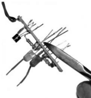
Slika 61: Potem ko dokončate in pregledate vezje, je treba prekomerne dolžine priključnih žic odščipniti s ploščatimi kleščami za elektronike.
