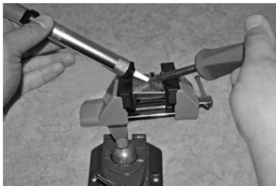
Slika 65: Odspajkanje deluje samo s pomočjo odspajkalne črpalke.
