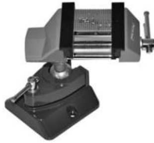
Slika 19: V primežu za finomehanike lahko dobro vpnete tiskana vezja in jih udobno spajkate.
