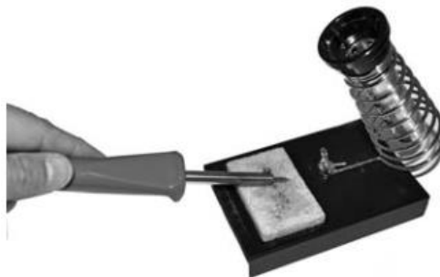
Slika 23: S časom se na spajkalni konici nabere spajka, ki znatno oteži nadaljnje spajkanje.
