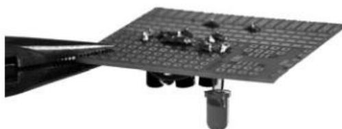
Slika 63: Priključne žice je treba odščipniti tik nad spajkanimi stožci.
