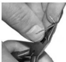
Slika 28: Žico pravilno upognete z okroglimi kleščami za elektronike.
