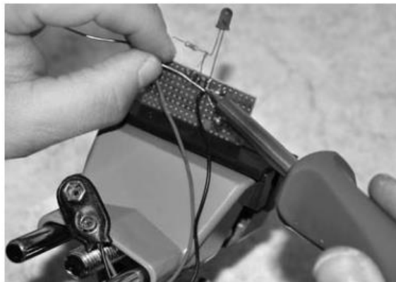
Slika 40: Na obeh zunanjih kontaktnih površinah je treba vstaviti žici baterijske sponke skozi še proste izvrtine in ju prispajkati.
