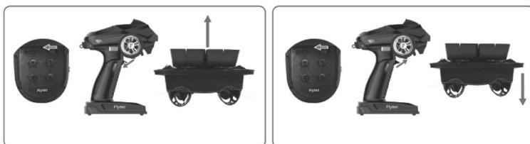
Če se želite vrniti v običajni plinski način, prestavite stikalo za plinski način v levo v položaj "NOR".
