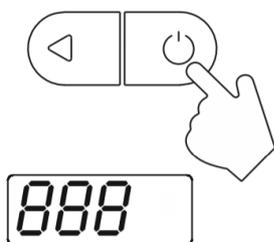
Če želite vklopiti napravo, pritisnite in držite tipko, dokler se segmenti ne zapolnijo.
