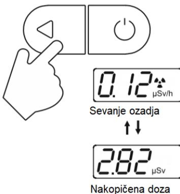
Preklop med načinom za merjenje sevanja ozadja in nakopičene doze poteka s kratkim pritiskom na tipko za izbiro načina.
