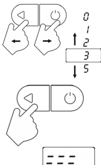
Vrednost ustrezne nastavitve se spremeni s pritiskanjem na desno ali levo nadzorno tipko.
