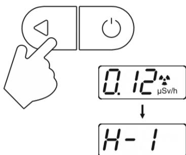
Če želite preklopiti v način nastavitve, pritisnite in držite tipko za izbiro načina v načinu za merjenje sevanja ozadja.
