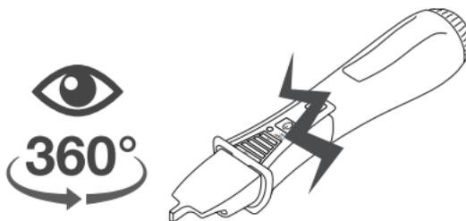
Redno preverjajte, da je naprava za testiranje napetosti nepoškodovana in varna za uporabo (na primer tako da se prepričate, da ohišje ni poškodovano ali deformirano).
