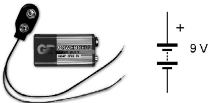
Slika 3: Baterija, prava in kot simbol vezja
