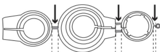
**OPOMBA:** Pred uporabo enega od priloženih adapterjev popolnoma odstranite priključke plastičnih adapterjev! Za adapterje Danfoss RA/RAV uporabite priloženi vijak in matico. Informacije o adapterjih: [www.eurotronic.org/Service/FAQ](http://www.eurotronic.org/Service/FAQ).
