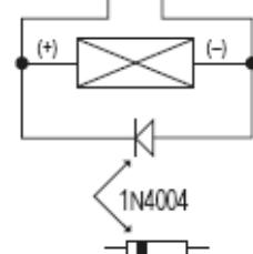
Izhod je predhodno konfiguriran za odpiralnik vrat "Fail-Secure", ki je običajen za vhodna vrata. Po potrebi lahko to spremenite s kratkostičnim mostičkom "DOOR LOCK" (J).
