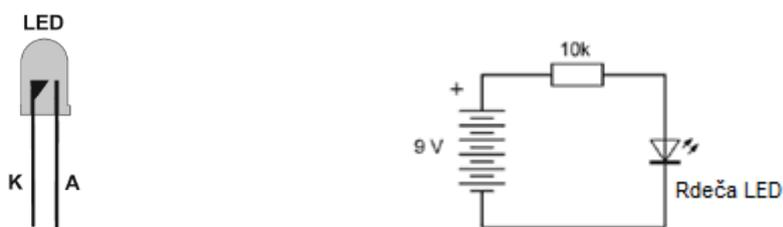
Vežalni načrt prikazuje zaporedno vezavo. Električni tok teče skozi baterijo, upor in LED. Upor ima pri tem nalogo, da omeji jakost toka na smiselno vrednost. Večji kot je upor, manjša je jakost toka. Pri  $10 \text{ k}\Omega$  LED-dioda sicer deluje daleč pod svojim maksimalnim možnim električnim tokom, vendar že dovolj močno sveti.
