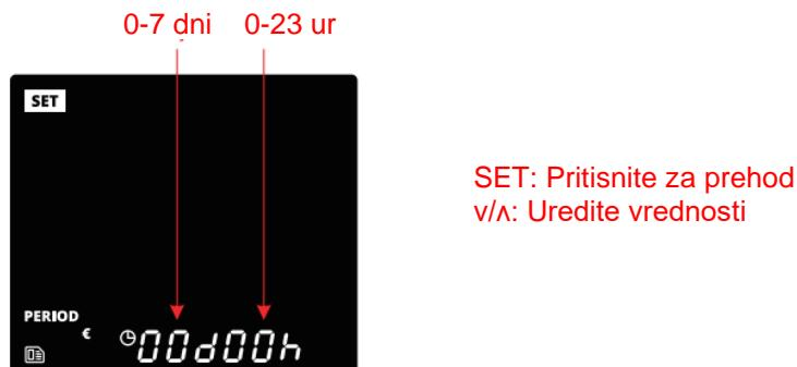
S pritiskom na tipko "R" boste izbrisali nastavitev in se vrnili na običajen prikaz na zaslonu.
