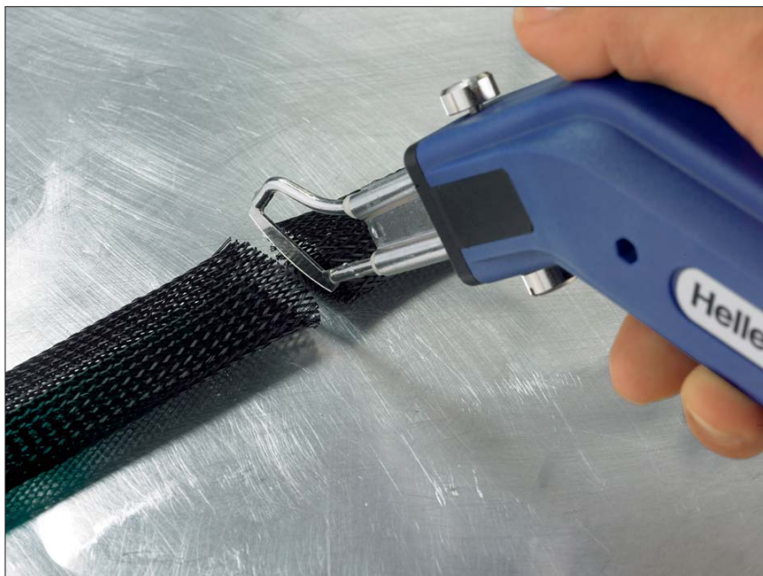
HSG0 värmekapverktyg skyddar den flätade skyddsstrumpan från att fransas.
