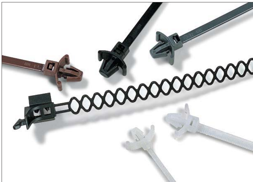
Ett brett urval av pilspetsband som passar till paneltjocklekar på 0,5 till 4,5 mm och håldiameterar på 4,4 till 8,0 mm.
