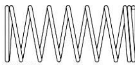
BD6 ×2 19805485 フロントコイルスプリング Front coil spring Vordere Feder Ressort hélicoïdal avant
