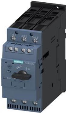
Leistungsschalter Baugröße S2 für den Motorschutz, CLASS 10 A-Auslöser 49...59 A N-Auslöser 845 A Schraubanschluss Standardschaltvermögen mit querliegenden Hilfsschalter 1S+1Ö
