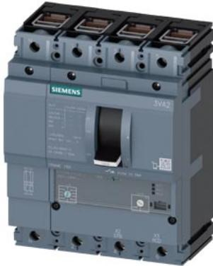
Leistungsschalter 3VA2 IEC Frame 160 Schaltvermögenklasse H Icu=85kA @ 415V 4-polig, Anlagenschutz ETU340, ELISA LI, In=40A Überlastschutz Ir=16A...40A Kurzschlusschutz Ii=15 x In N-Leiterschutz einstellbar (OFF, 100%) Klemmenanschluss
