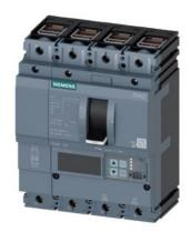
Leistungsschalter 3VA2 IEC Frame 160 Schaltvermögenklasse C Icu=110kA @ 415V 4-polig, Anlagenschutz ETU850, LSI, In=63A Überlastschutz Ir=25A...63A Kurzschlussschutz Isd=0,6..10x In, Ii=1,5..12x In N-Leiterschutz einstellbar (OFF, bis 160%) Klemmenanschluss
