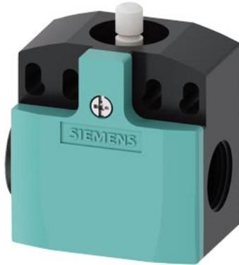
Positionsschalter Kunststoffgehäuse 50mm, Geräteanschluss 2 x (M20 x 1,5) 1S/1Ö Sprungkontakte Kurzhub integriert Kuppenstößel
