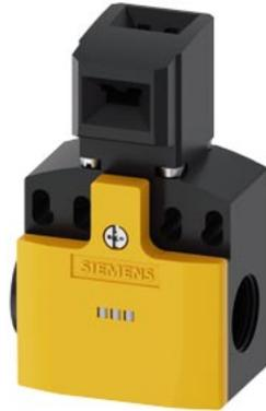
Sicherheits-Positionsschalter mit getrenntem Betätiger Kunststoffgehäuse, 50 mm Geräteanschluss 2x (M20x 1,5) Schleichschaltglieder 1S+2Ö mit 2 LEDs gelb/grün DC 24 V 5 Anfahrrichtungen der dazu passende getrennte Betätiger 3SE5000-0AV0. muss separat bestellt werden
