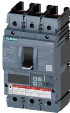
Leistungsschalter 3VA6 UL Frame 150 Schaltvermögenklasse C 100kA @ 480V 3-polig, Anlagenschutz ETU860, LSIG, In=100A Überlastschutz, 100% rated Ir=40A...100A Kurzschlusschutz Isd=0,6..10x In, li=1,5..12x In N-Leiterschutz optional mit externem Stromwandler, bis 160% Erdschlusschutz Ig=0,2...1 x In, tg=0,05-0,8s ohne Anschluss
