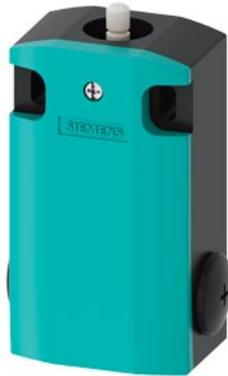
Basisschalter für Positionsschalter 3SE5162 Metallgehäuse XL, 56 mm breit Geräteanschluss 3x(M20 x 1,5) IP66/IP67 2 x (1S/2Ö) Schleikontakte mit Überschneidung ohne Antriebskopf
